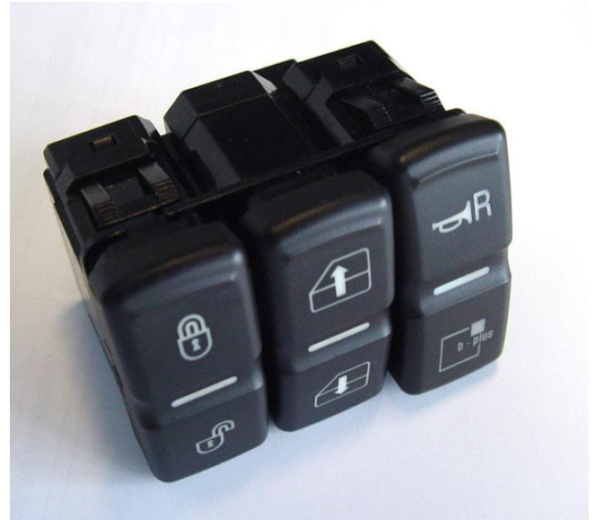
Abbildung 1: Master Modul mit SAE J1939 Schnittstelle, kundenspezifisch gravierten Kippschaltern mit 3 facher Rastfunktion
