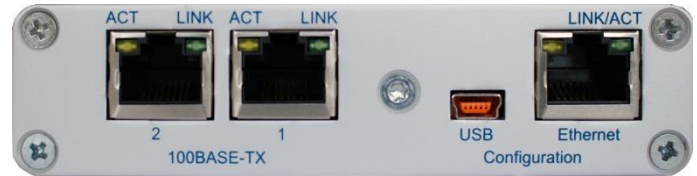
Abbildung 3: 100Base-TX Schnittstellen, Konfigurationsschnittstellen USB und Ethernet
