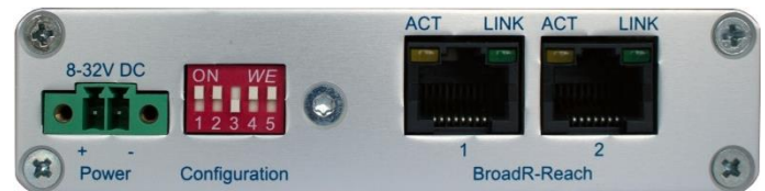
Abbildung 4: Anschlüsse für Power, DIP Schalter zur Konfiguration ohne SW-Tool und BroadR-Reach® Schnittstellen
