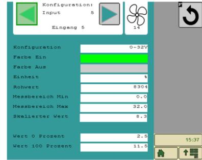
Konfigurationsmaske eines Eingangs
