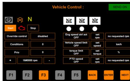
Abbildung 3: F3 - Beeinflussung der Motorsteuerung
