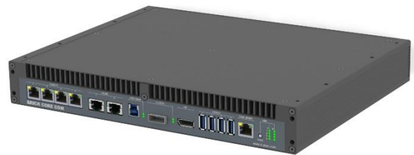
Abbildung 1: BRICK CORE COM (aktiv gekühlte Variante)
