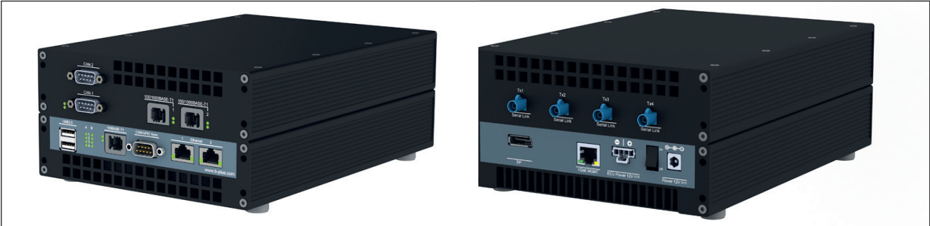
Bild 1. Front- und Rückansicht des b-HiL Systems mit fünf Inputs und 14 Outputs. (Bild: b-plus)
